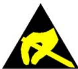
即使远远低于人类所能感知范围的电压和电力水平也将对 ESD 造成损坏。如果有人未进行接地处理就触摸了一个元件或模块，就能产生这样的电压。暴露于此类电压的元件一般不会立即损坏——该元件或模块在运行一段时间之后才会开始出现异常现象。
